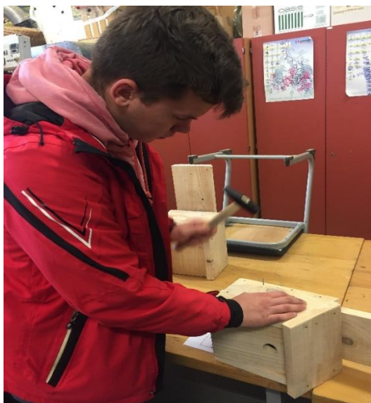
Slika 3: Zbijanje končnih delov gnezdilnice.
